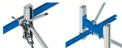
El refuerzo trasero y el arriostamiento horizontal aseguran las tolerancias de montaje requeridas (FEM 9.832).
